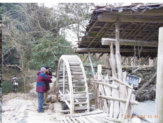
写真20 繞南古制瓷遺址区の砕石用水車
