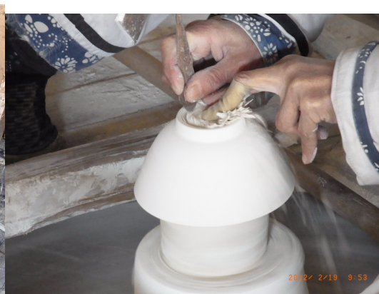
写真4 高台内削り込み
